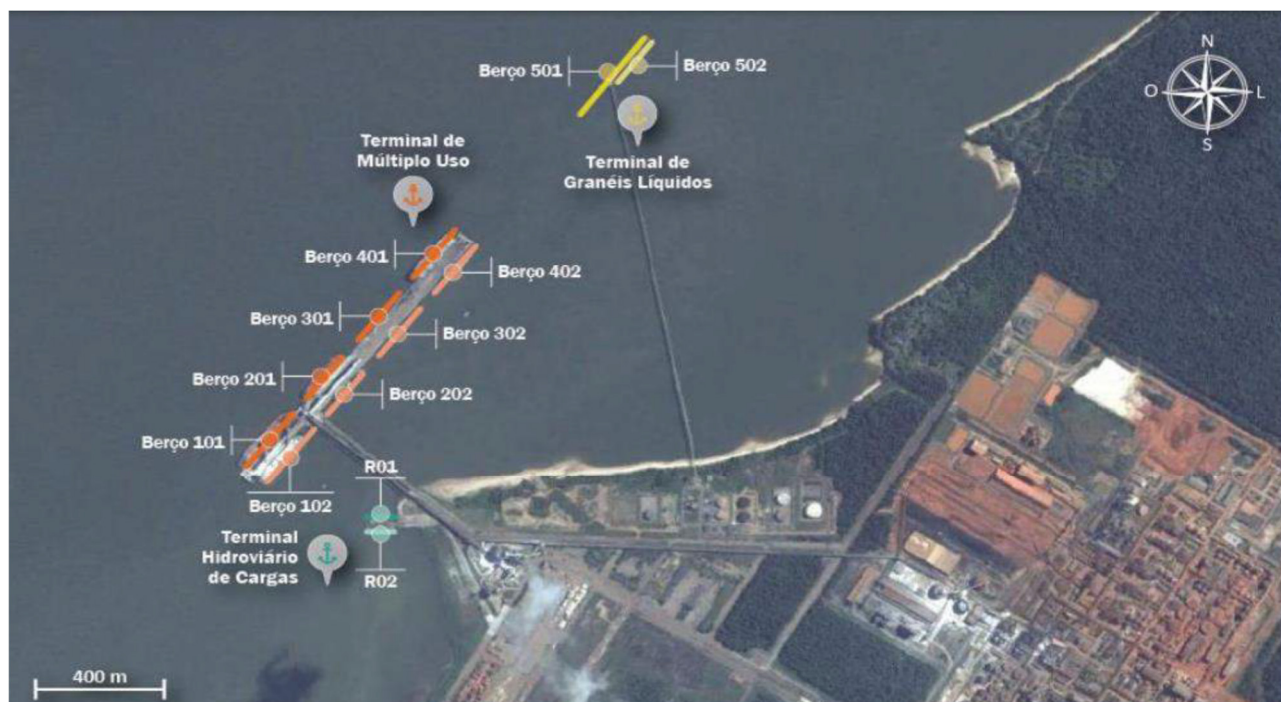
Figura 2 - Infraestrutura de acostagem do Porto de Vila do Conde.
